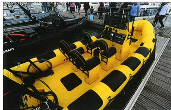
Les quatre assises jockey offrent un bon confort pour les passagers en navigation. Elles disposent de coffres de rangement.
