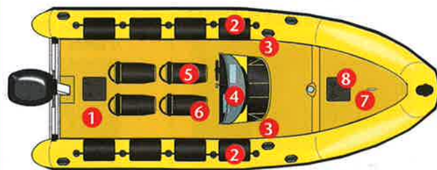
Un 150 ch Mercury 4 temps EFI est installé sur le tableau arrière. À l'avant, le cockpit est équipé d'une petite plateforme surélevée.
