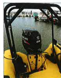
Un 150 ch Mercury 4 temps EFI est installé sur le tableau arrière. À l'avant, le cockpit est équipé d'une petite plateforme surélevée.
