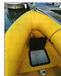
La console surmontée d'un pare-brise protecteur est dotée d'une assise coffre à l'avant. La baïlle montre des dimensions suffisantes pour recevoir le mouillage.
