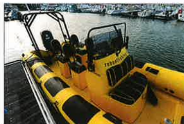
La console surmontée d'un pare-brise protecteur est dotée d'une assise coffre à l'avant. La baïlle montre des dimensions suffisantes pour recevoir le mouillage.
